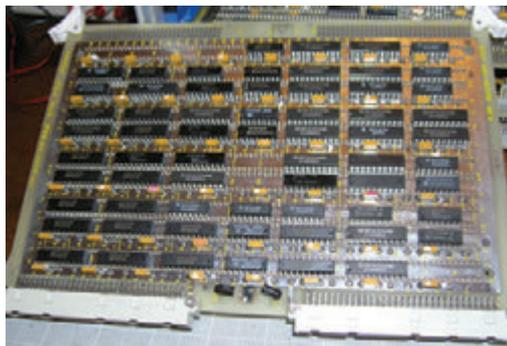
**Рис. 4.63.** Любитель Билл Базби (Bill Buzbee) самостоятельно собрал веб-сервер полностью на логических микросхемах серии 7400, самая старая из которых была произведена в конце 1969 г. Этот веб-сервер можно найти в Интернете по адресу <http://magic-1.org>, где приведены фотографии его самого и подробности его конструкции. На рисунке, который представил Билл, показана всего лишь одна плата из его замечательного проекта
