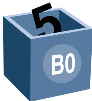
**Рис. 5.140.** Чтобы понять, как работает программа, нужно представить переменную в виде «ячейки памяти» с собственным именем, которое закреплено на ее внешней стороне, и числом, которое находится внутри ее
