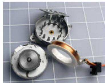
**Рис. 5.113.** Если разобрать шаговый двигатель, то это будет что-то похожее на это, что вы обнаружите внутри. Слева показан ротор двигателя, который имеет магнитный пояс по окружности, он прочно прикреплен к нижней половине корпуса. Справа верхняя половина корпуса в открытом состоянии и со снятыми катушками (фактически, как вы можете видеть, обмотка состоит из двух катушек, намотанных в противоположном направлении). Выступы это магнитные сердечники, которые приводят в движение ротор
