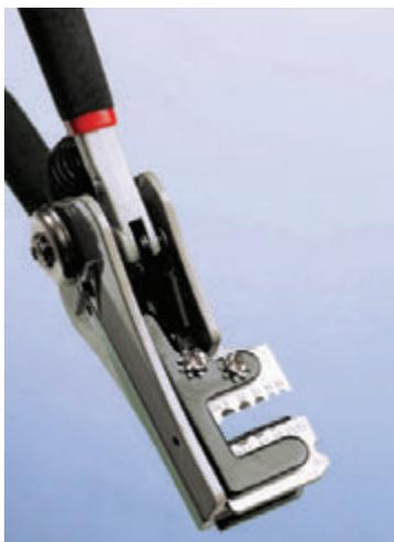
**Рис. 2.5.** Такие автоматические устройства для снятия изоляции дают возможность выполнять эту операцию, используя только одну руку, но непригодны для снятия изоляции с проводов малой толщины (см. подразд. «Инструменты» разд. Эксперимент 6. Очень простое переключение» этой главы)
