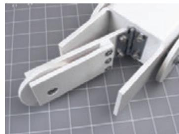
**Рис. 5.95.** Крупный план рулевого колеса, которое свободно поворачивается на петле и может перемещаться из стороны в сторону с минимальным трением
