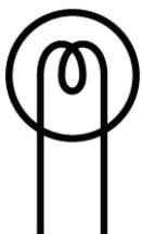
**Рис. 2.42.** Символ для графического изображения лампы накаливания
