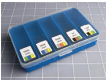
**Рис. 5.6.** Чтобы сразу видеть, что резисторы находятся в соответствующем отсеке, нужно на каждой наклейке напечатать цветовую кодовую маркировку резистора
