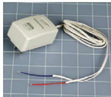
**Рис. 3.45.** Одножильные провода разного цвета, припаянные к проводам сетевого адаптера, для удобной подачи напряжения на макетную плату. Следует помнить, что они имеют разную длину, чтобы уменьшить риск касания друга в месте соединения
