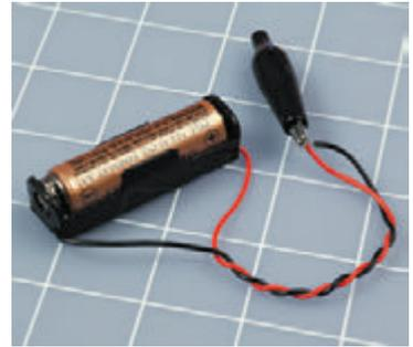
**Рис. 1.28.** Замораживание щелочной батарейки может быть безопасным, если вы будете точно следовать приведенным далее указаниям. Даже в этом случае батарейка может стать слишком горячей, что касание к ней может вызвать неприятные ощущения. Обращаю ваше внимание на то, что в эксперименте не следует использовать аккумуляторы любого типа!
