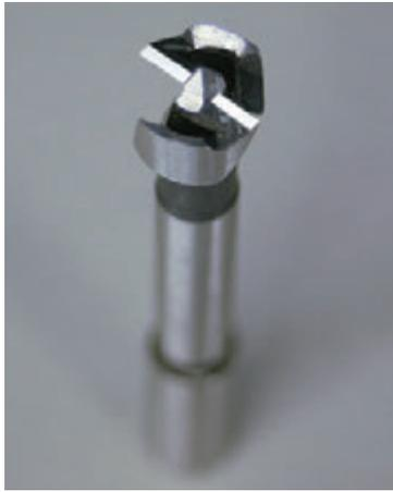
**Рис. 5.83.** С помощью специального сверла Форстнера (Forstner) можно выполнять чистые и аккуратные отверстия; обычное сверло большого диаметра будет «зажевывать» АБС-пластик, что безусловно будет приводить к браку
