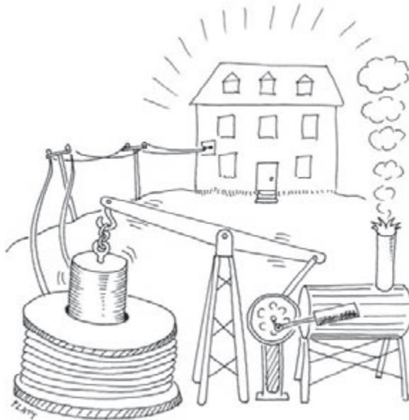
**Рис. 5.22.** Поскольку индуктивность возрастает прямо пропорционально диаметру катушки и квадрату числа витков, полученная вами мощность на выходе от перемещения магнита через катушку может возрасти в значительной степени. Те, кто желает жить без использования сетей энергоснабжения, могут рассчитать такую конструкцию с использованием пара с достаточной мощностью для дома с тремя спальнями
