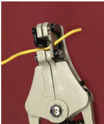
**Рис. 2.19.** Использование автоматического инструмента для удаления изоляции, когда вы сжимаете рукоятки, губки слева зажимают провод, а острые лезвия с вырезами справа надкусывают изоляцию. Увеличение сжатия приводит к тому, что губки и лезвия отходят друг от друга, снимая изоляцию с провода
