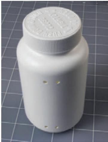
**Рис. 5.60.** Большая пустая бутылка из-под витаминов диаметром 3" (76,2 мм) представляет собой идеальный каркас для катушки детекторного приемника. Просверленные отверстия будут удерживать провод, намотанный на бутылке
