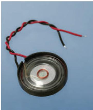
**Рис. 2.16.** Этот миниатюрный динамик диаметром немногим более 1" (2,54 см) применяется в транзисторных цепях для проверки аудиовыхода
