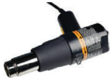
**Рис. 3.9.** Похожий на мощный фен для волос промышленный фен используется для теплового воздействия на термоусадочную трубку, за счет которой создается прочная изолированная оболочка вокруг оголенного провода
