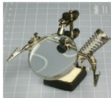
**Рис. 3.3.** Держатель оснащен двумя «крокодилами» для фиксации вашего изделия. Металлическая спираль это держатель для фиксации вашего разогретого паяльника, а губка предназначена для очистки его жала
