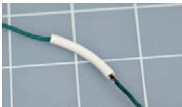
**Рис. 3.42.** Наденьте трубку на ваше соединение проводов
