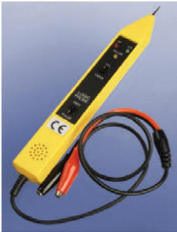
**Рис. 4.1.** Логический пробник позволяет определить уровень напряжения на каждом выводе микросхемы, а также показывает наличие импульсов, которые могут быть слишком короткими, чтобы их можно было заметить невооруженным глазом
