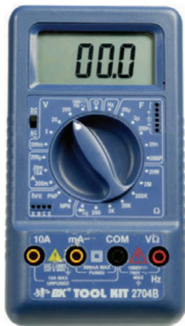
**Рис. 1.5.** На моем собственном любимом мультиметре вы можете заметить следы износа и даже царапины. У него есть все необходимые основные функции, и он может измерять емкость (диапазоны обозначены буквой «F»). Кроме того, с его помощью можно проверить исправность транзисторов. Однако при работе с этим мультиметром диапазоны измерения надо устанавливать вручную
