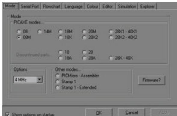
**Рис. 5.126.** Эта копия экрана показывает вкладку окна с параметрами программы редактирования PICAXE Program Editor, которую вы должны использовать для выбора типа микросхемы для ее программирования (в нашем случае это микроконтроллер 08M)
