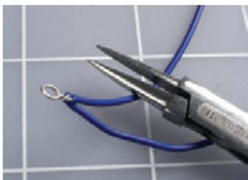
**Рис. 5.62.** Каждая оголенная часть провода согнута в петлю с помощью тонкогубцев
