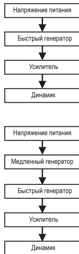
**Рис. 2.106.** Верхняя часть рисунка: блок-схема генератора звуковых колебаний, работающего на относительно высокой частоте («быстрый» генератор). Нижняя часть рисунка: блок-схема генератора, в котором добавлен относительно низкочастотный («медленный») генератор для управления другим («быстрым») генератором, работающим на более высокой частоте
