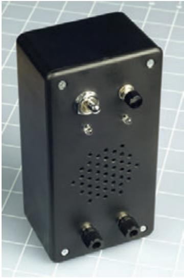
**Рис. 3.93.** Пульт управления охранной сигнализацией завершен и собран в корпусе
