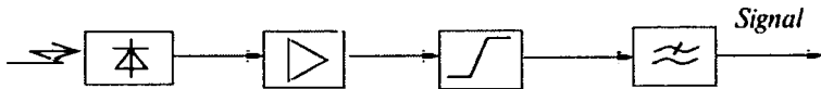
6.15-rasm. Intensivlik bo'yicha analog ko'rinishda modulyatsiyalangan yorug'lik nurlanishini bevosita qabul qilish sxemasi.
