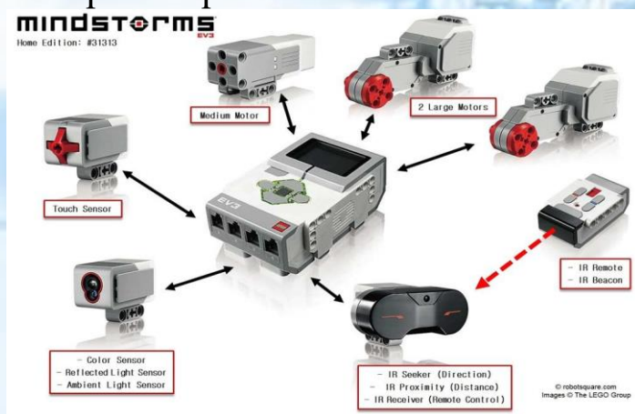
3.7-Rasm. Lego Mindstroms to'plamiga kiruvchi EV3 mikrokontrolleri
