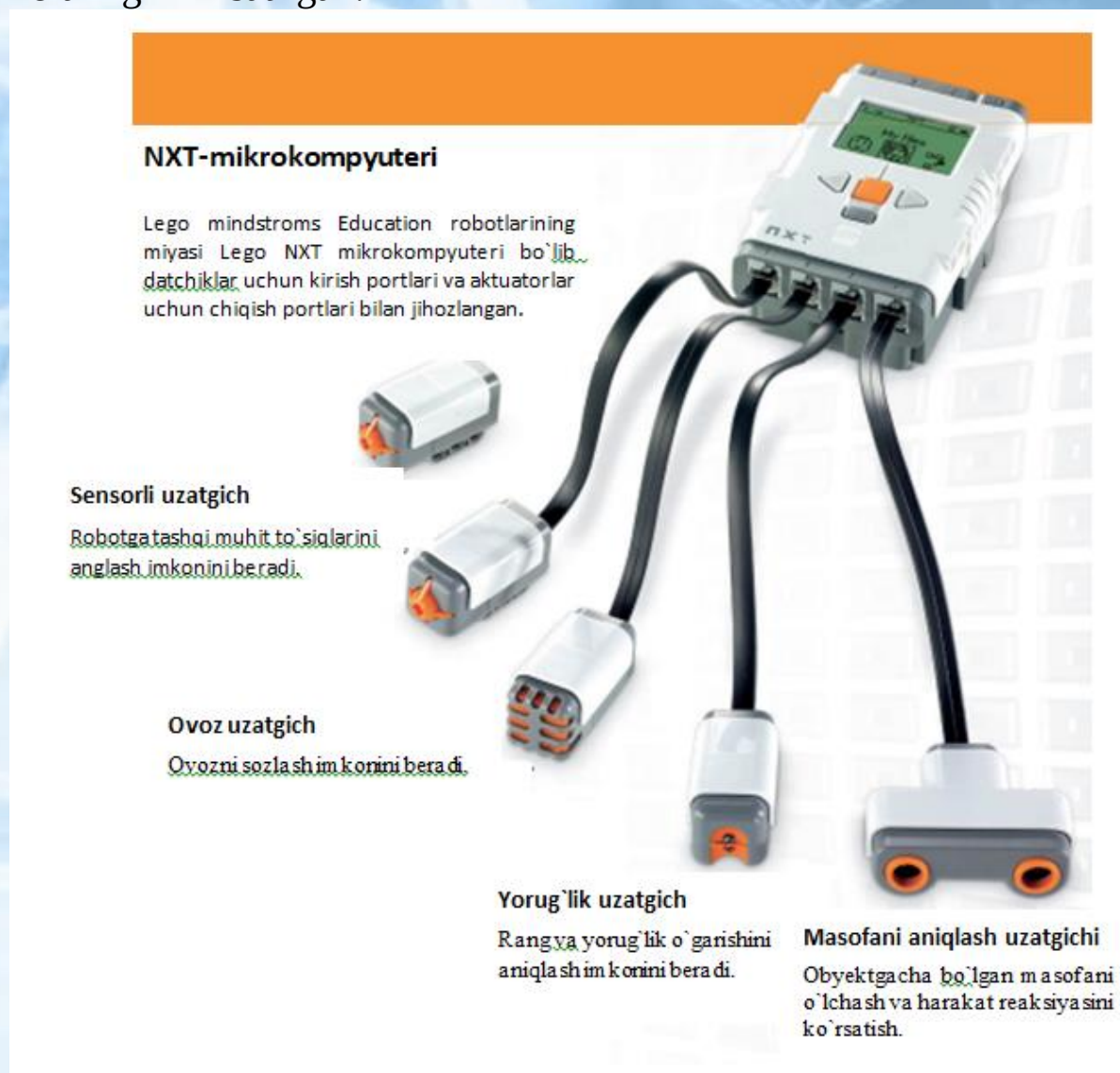
4.3-Rasm. Lego NXT mikrokompyuteri tuzilishi
