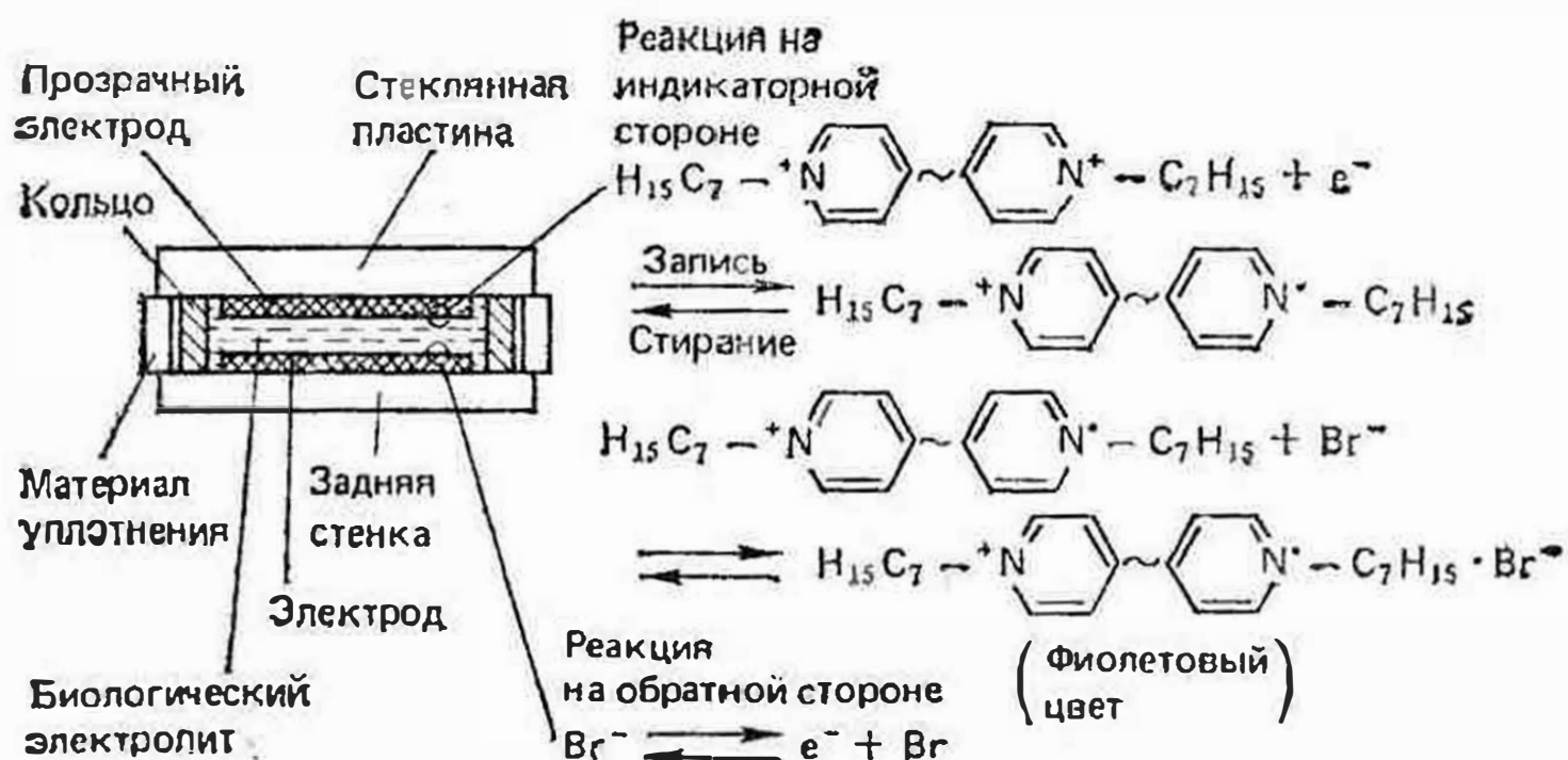
Рис. 26. Элемент электрохромной матрицы на основе биологического вещества с бромидом калия
