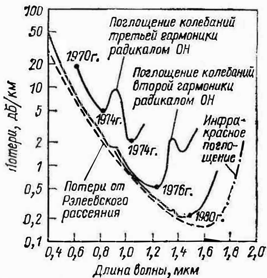
Рис. 110. Характеристики потерь в кварцевых волокнах
