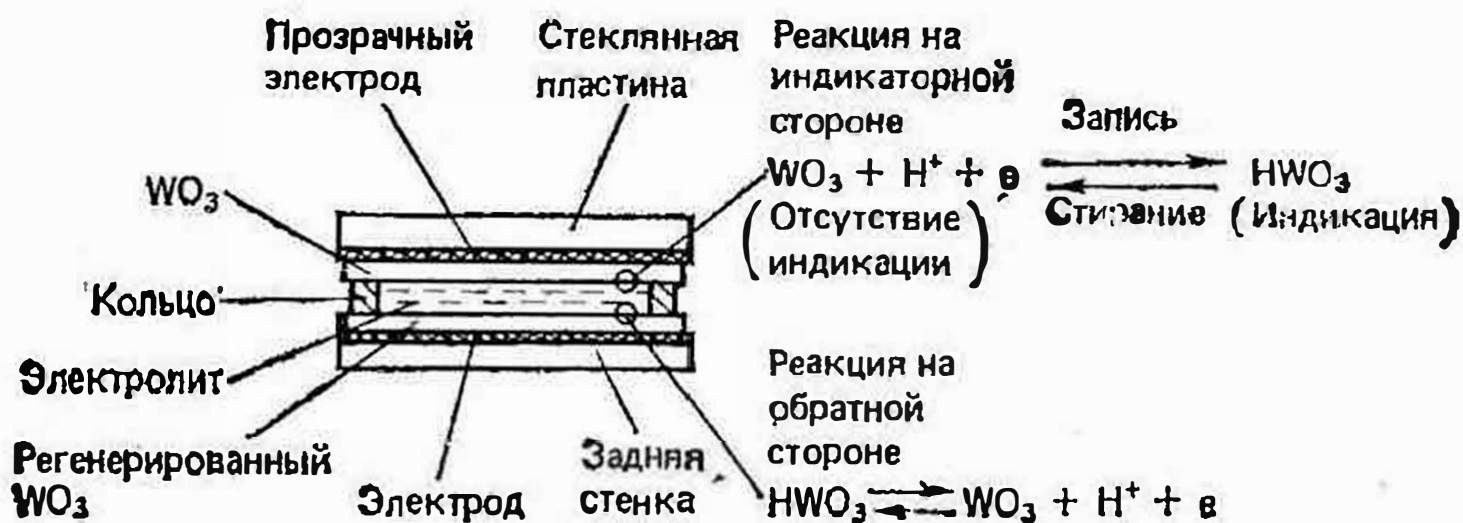
Рис. 25. Элемент электрохромной матрицы на основе вещества \text{WO}_3
