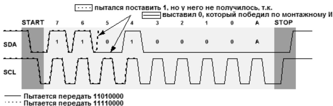
Рисунок 54. Арбитраж между двумя ведущими (случай одновременной передачи данных)
