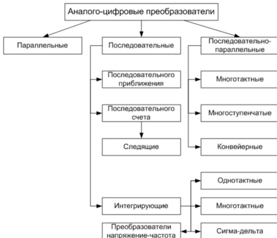
Рисунок 40. Классификация АЦП по методам преобразования
