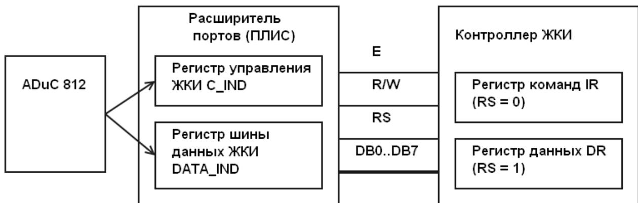
Рисунок 94. Регистры, необходимые для работы с ЖКИ: слева регистры расширителя портов, справа, регистры контроллера ЖКИ. Для доступа к регистрам контроллера ЖКИ вы должны сформировать на шине сигналы, с помощью регистров расширителя портов.
