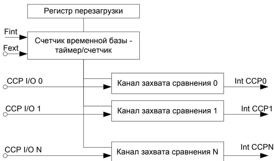
Рисунок 38. Блок процессора событий
