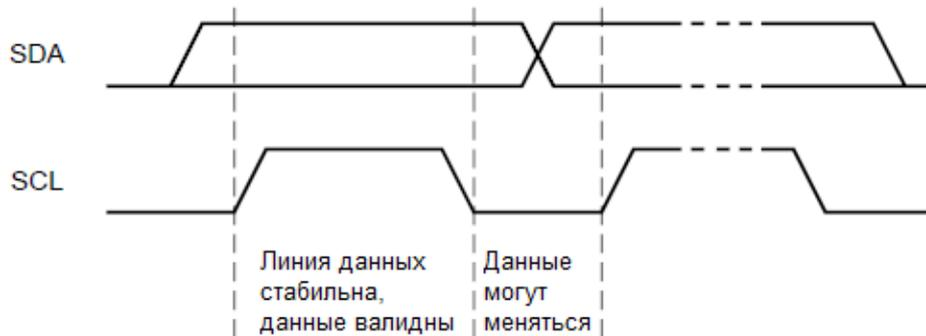
Рисунок 50. Пересылка бита по шине I<sup>2</sup>C
