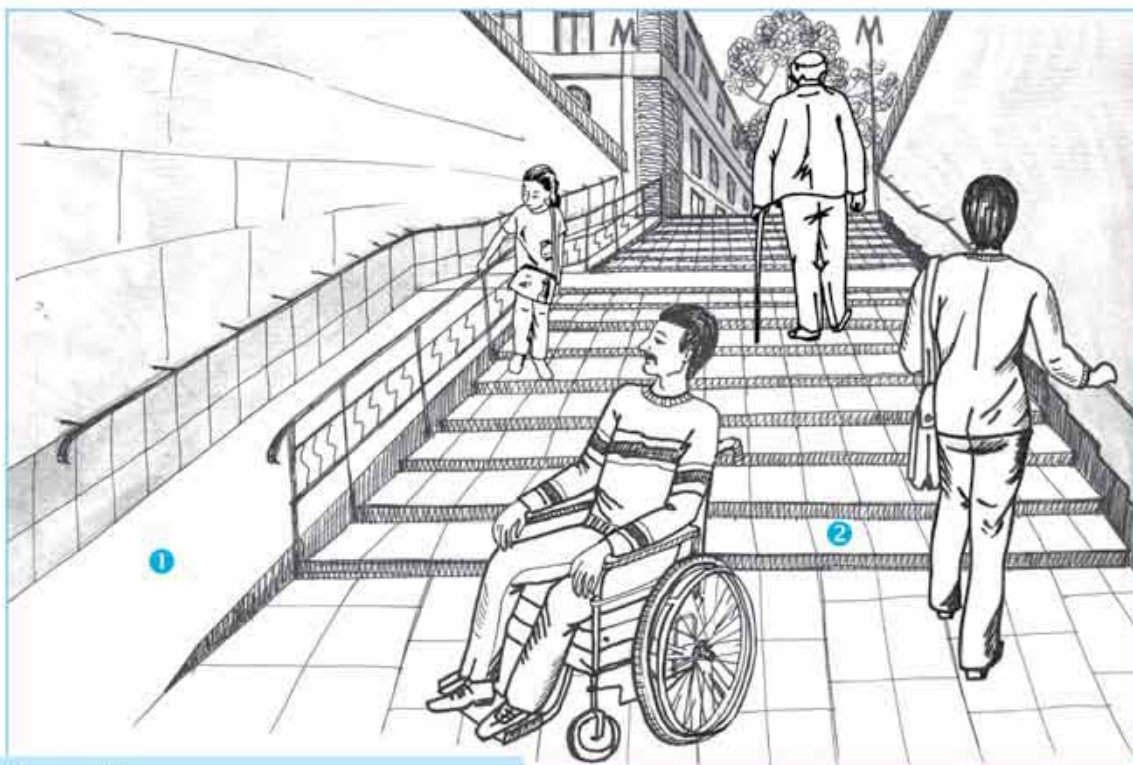
10- расм. Таянч-ҳаракатлашнинг ашпаратида нуқсонга эга кишилар учун метро станцияси ҳамда ер ости ўтиш жойларида зинапоё билан параллель равишда пандусли зинапоёларнинг кириш комплекси варианты:
