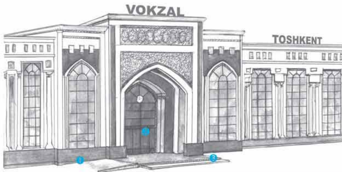
13-расм. Ногиронлиги бор кишилар учун вокзал (аэропорт, автовокзал ва б.ларга.) мосламали кириш зонаси: 1 — курси-аравачада ҳаракатланадиган кишилар учун пандус; 2 — остонасиз технологияга асосланган, икки томонга суриладиган эшик; 3 — умумий фойдаланиш зинапояси;
