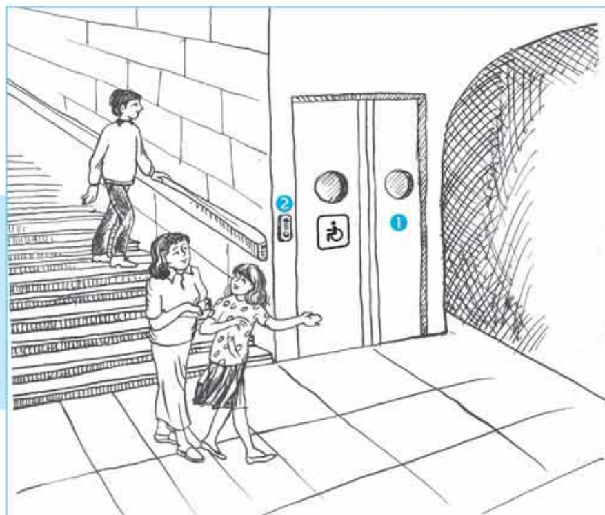
12-расм. Ногиронлиги бор инсонлар учун метро кираверишида ўрнатилган лифт фрагменти: 1 — лифтга кириш; 2 — ногиронлиги бор инсонлар эҳтиёжларини ҳисобга олган ҳолда лифтнинг бошқарув панели.
